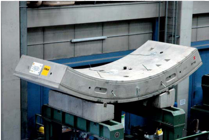
Prüfung eines Tübbings unter Temperaturlast
