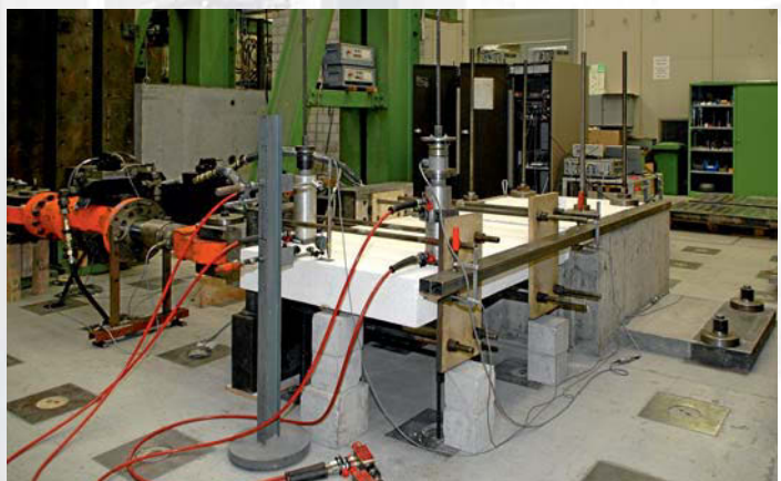
Prüfung an einer Kragplatte
