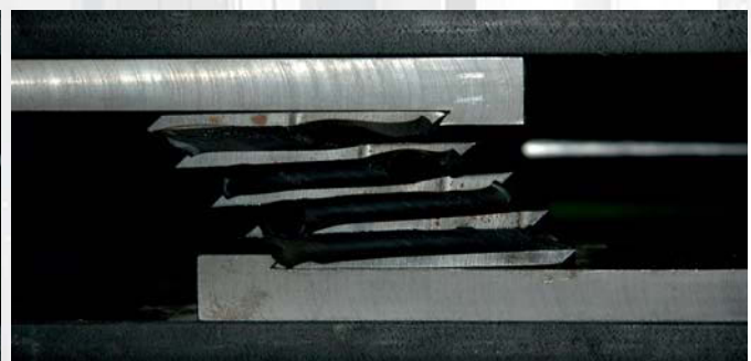
Schubverbundprüfung nach DIN 4141-140 Versuchsbeginn (links) und Versuchsende (rechts)
