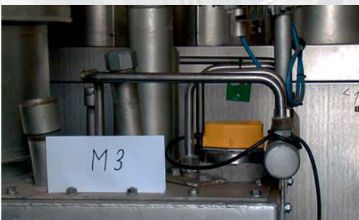
Schwingungsmesssystem im Einsatz
