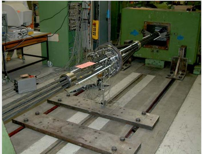
Spannglied mit Kopplung im Dauerschwingversuch
