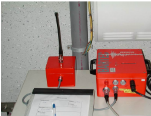
Erschütterungsmessstation mit Funkmodem zur Fernüberwachung von Bauwerksschwingungen
