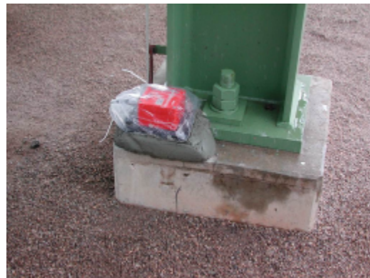
Erschütterungsmessstation mit Funkmodem zur Fernüberwachung von Bauwerksschwingungen
